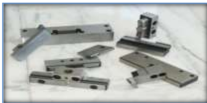
Fig.1. Piese obținute prin șanțare
